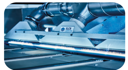
Nach der Strukturierung folgt die Reinigung der Bipolarplatten
