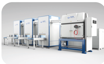
Anlagenbeispiel 2: Anlage zur Entschichtung von Radkalotten (Lackieren ohne maskieren)
